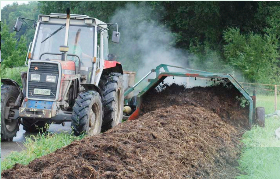
Die Wendemaschine mischt das Material und bringt dabei Sauerstoff in die Miete hinein. Dies unterstützt den Reifungsprozess. Beim Wenden entweicht Wasserdampf. Foto: Katharina Scheuner
