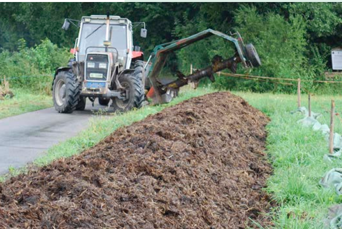
Das Material wird über die Umsatzwelle nach hinten befördert, dabei gewendet und gemischt. Foto: Katharina Scheuner
